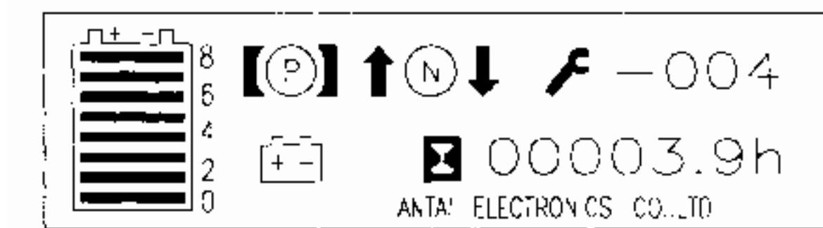
**(1). Поворотом ключа в положение ВКЛ ("ON"), включается электрическая цепь управления.**
