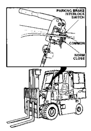
22. TRANSMISSION DOES NOT OPERATE IN FORWARD OR REVERSE (CONT).
