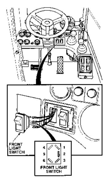
7. TAILLIGHTS, FRONT LIGHT, GAUGE LIGHTS, AND MAST LIGHT DO NOT OPERATE (CONT).
